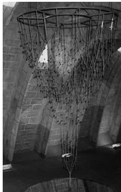
FIGURA 2.1 Esquerda: método gráfico de Méry. Direita: modelo de Gaudí para o dimensionamento de cúpulas através do método da catenária (adaptado de Gago, 2004).
