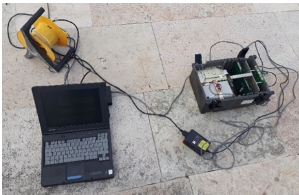
FIGURA 5.3 Esquerda: material utilizado na realização dos ensaios de caracterização dinâmica. Direita: definição das direções X e Y na planta em estudo (adaptado de SIPA, 2017).
